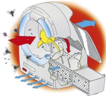
Ce **PIÈGE ASPIRATEUR VOLANTS** est idéal pour une utilisation dans les zones domestiques et publiques (entrepôts, commerces de bouche, hôtels...) nécessitant la détection et le contrôle des insectes volants. Le piège peut être posé sur une surface plane ou fixé au mur. Il se branche directement sur une prise électrique. Un piège couvre une surface d'environ 50 m<sup>2</sup>.
